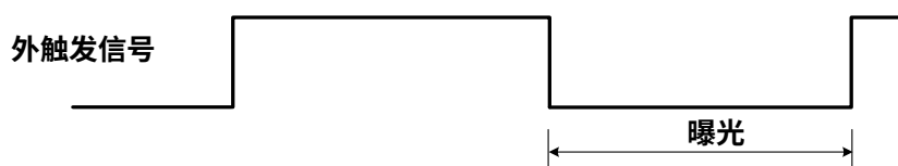
图 8-29 下降沿触发宽度曝光模式时序图
