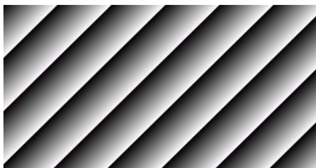
图 8-45 静止斜条纹测试图
