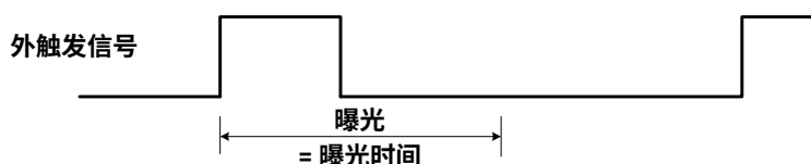
图 8-26 上升沿触发定时曝光模式时序图
