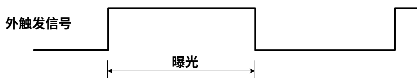
图 8-28 上升沿触发宽度曝光模式时序图
