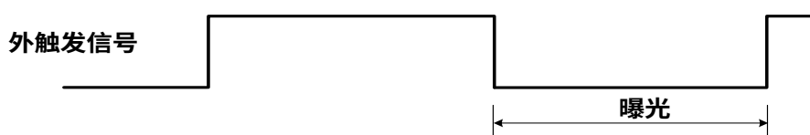
图 8-27 下降沿触发宽度曝光模式时序图
