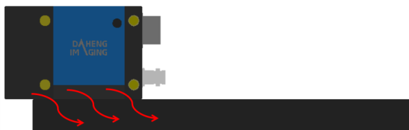
图 2-2 相机安装固定板
