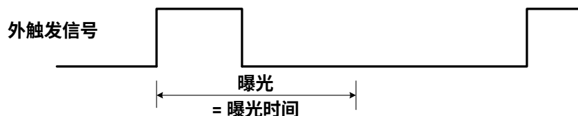
图 8-24 上升沿触发定时曝光模式时序图
