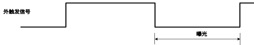
图 8-26 下降沿触发宽度曝光模式时序图
