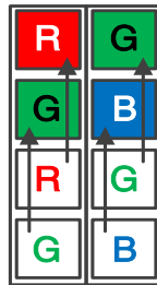
图 8-39 彩色相机垂直 Binning 系数为 2
