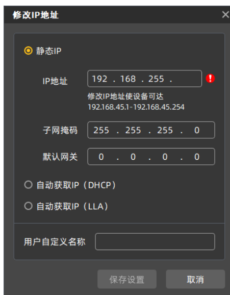
图 9-5 IP 配置工具 IP 地址格式检查
