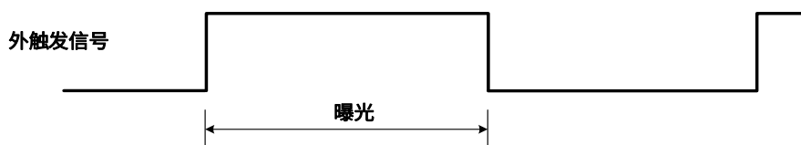
图 8-25 上升沿触发宽度曝光模式时序图
