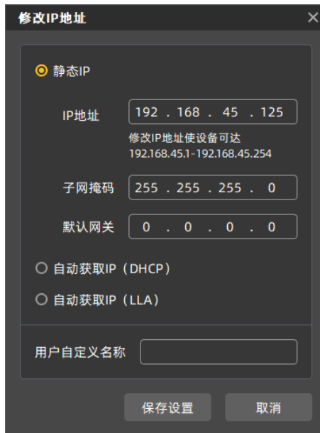
图 9-4 配置工具修改相机 IP 地址
