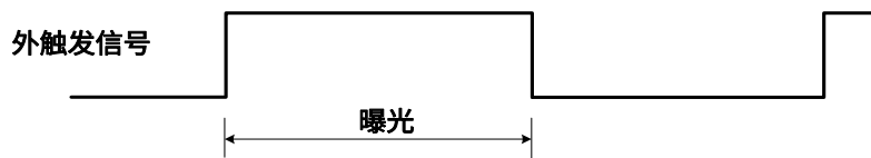
图 8-30 上升沿触发宽度曝光模式时序图
