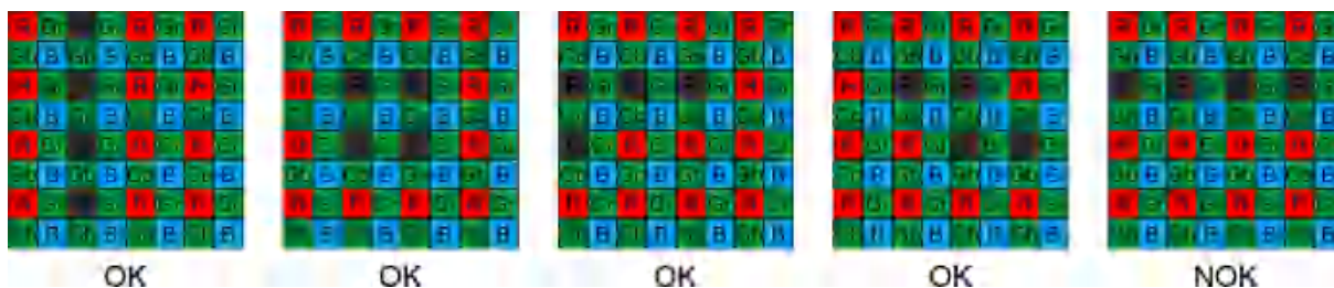
图 4-52 ME2P-2622-15U3C 连续坏点为相同颜色分量分布情况示意图
