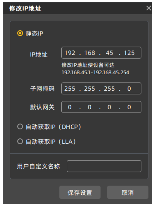
图 9-4 配置工具修改相机 IP 地址
