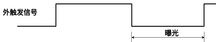
图 8-30 下降沿触发宽度曝光模式时序图
