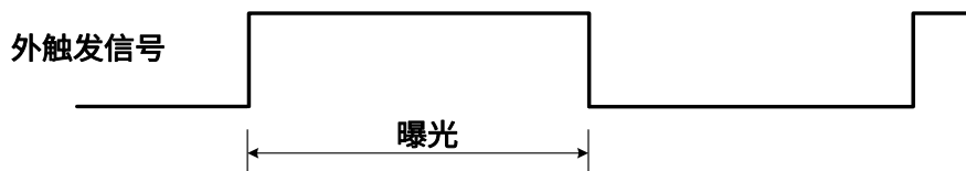
图 8-29 上升沿触发宽度曝光模式时序图
