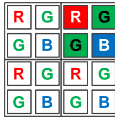
图 8-49 彩色相机水平垂直 Binning 系数 2x2
