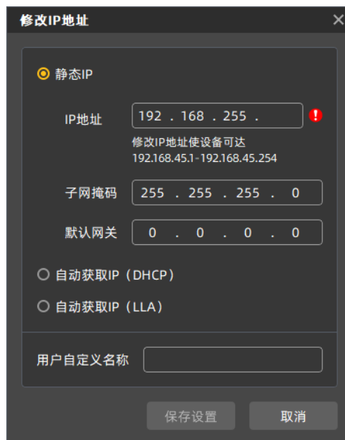
图 9-5 IP 配置工具 IP 地址格式检查
