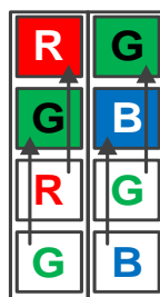
图 8-48 彩色相机垂直 Binning 系数为 2
