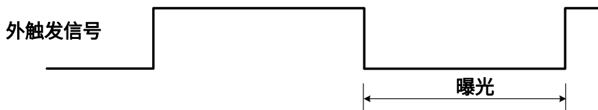
图 8-30 下降沿触发宽度曝光模式时序图
