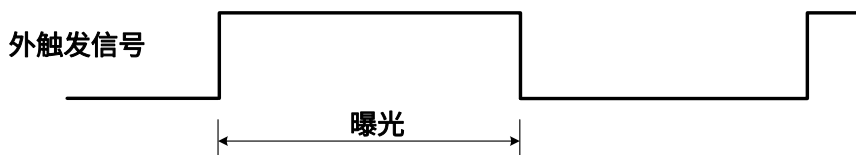
图 8-29 上升沿触发宽度曝光模式时序图
