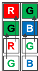
图 8-46 彩色相机垂直 Binning 系数为 2
