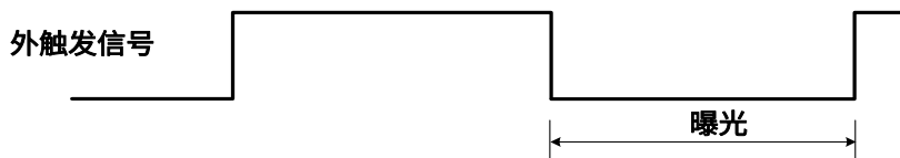
图 8-27 下降沿触发宽度曝光模式时序图
