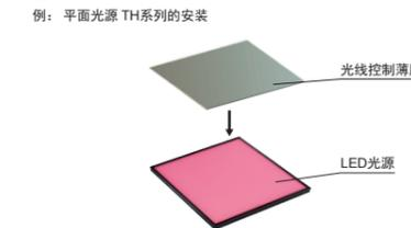
注意事项 偏光板为消耗品。根据使用的环境,可能会因高温而发生变形和变色。请注意采取散热措施,以防止超过耐热温度。
