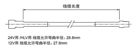
※使用机器人线缆时, 请固定包括光源侧的端口连接部的电缆部分。
