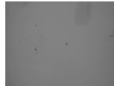
使用同轴光源时,表面整体被均匀照射,难以检测凹凸状态。
