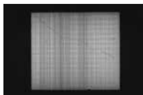
因表面发纹反射而难以使损伤成像。
