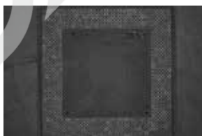
使用环形光源难以使底层与通孔之间的差异清晰地成像。
