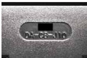
难以读取表面的刻印字符。
