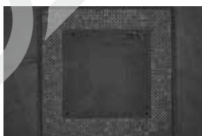
使用环形光源难以使底层与通孔之间的差异成像。
