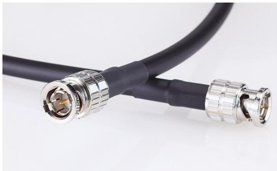
CoaXPress (CXP) 是一种非对称的高速串行通信数字标准。该标准接口容许设备通过一根或者几根同轴电缆传输视频和静止图像。在一根电缆里可传输最高达6.25Gb/s的视频、图像、数据信号等；以固定比特率20Mb/s控制信号进行通信；支持POWER·OVER·CABLE(“Power-over-Coax”)传输距离可达100m以上。
