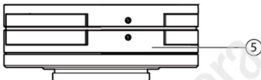
ZEISS Dimension レンズのバックフォーカス距離 (= レンズ取り付け面とカメラセンサーの距離) は約 17.53 mm (空気換算長) で、納品時には物体距離が無限になっています。最適なイメージオリエターを得るには、バックフォーカス距離の調節によってカメラマウントの寸法許容差を補正する必要があります。
