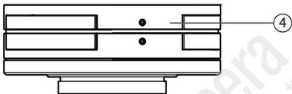
ZEISS Dimension 镜头配有用于调节方位角位置的环。因此可对镜头进行调节，以确保无论安装在何处均能获得刻度的最佳可读性。
