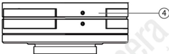
ZEISS Dimension Objektivs haben einen Ring zur Anpassung der azimutalen Ausrichtung. Es ist also möglich, das Objektiv so einzustellen, dass unabhängig von der Einbaulage eine optimale Lesbarkeit der Skalen gewährleistet ist.
