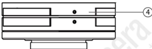
Объективы ZEISS Dimension оснащены кольцом для регулировки азимутального положения. С его помощью вы можете обеспечить наиболее четкую видимость шкал независимо от положения установки.
