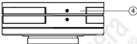
Les objectifs Dimension de ZEISS sont équipés d'une bague d'ajustement de la position azimutale. Il est ainsi possible d'ajuster l'objectif afin de garantir une lisibilité optimale des échelles, indépendamment de l'emplacement d'installation.
