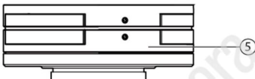
Номинальный рабочий отрезок (т. е. расстояние между плоскостью крепления объектива и светочувствительной матрицей камеры) для поставляемых компанией ZEISS объективов Dimension составляет около 17,53 мм в воздухе при установке фокусного расстояния на бесконечность. Для обеспечения оптимального качества изображения необходимо компенсировать допуски креплений камеры, отрегулировав заднее фокусное расстояние.
