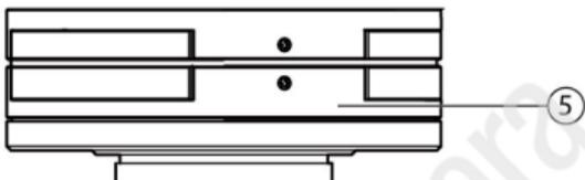
ZEISS Dimension Objektive haben bei der Auslieferung ein Nominal-Anlagemaß (= Abstand zwischen der Objektivanlagefläche und dem Bildsensor) von rund 17,53 mm in Luft bei unendlicher Objektentfernung. Um eine optimale Bildqualität zu erreichen, ist es nötig die Kameratoleranzen des Kamera-Mount durch Einstellung der Objektiv-Schnittweite zu kompensieren.
