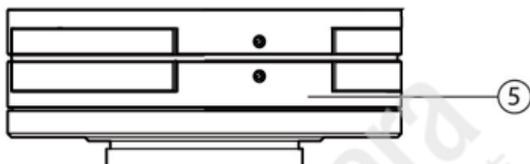
供货时，ZEISS Dimension 镜头在空气中无限物距的情况下的标称法兰焦距 (= 镜头安装面与相机传感器之间的距离) 为约 17.53 mm。为确保最佳的图像质量，需要通过调节后焦距补偿相机卡口的公差。
