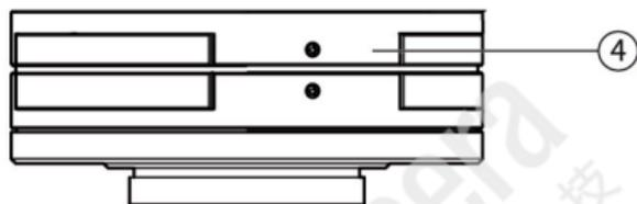
Gli obiettivi ZEISS Dimension hanno una ghiera per regolare la posizione azimutale. In questo modo è possibile regolare l'obiettivo per garantire leggibilità delle scale indipendentemente dalla posizione di installazione.
