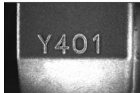
可抑制磨砂面的影响，实现仅强调字符的成像。
